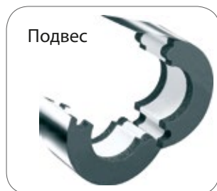
Комбинированное изделие из двух пенополиуретановых полуколец (к торцам приклеены полукольца из теплоизоляционного материала надлежащей марки, с наружным бандажом из ПВХ, имеющим самоклеящийся нахлест по продольному шву)
